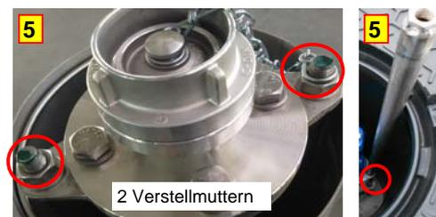
Verstellung der TELE Garnitur mit der Kupplungsmuffe an den Verstellmuttern M 16 Schlüsselweite 24
