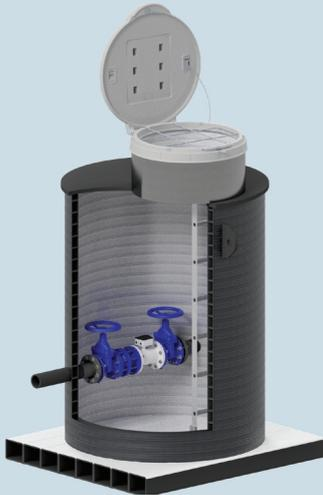
Ein Mess- und Kontrollschacht ist eine Schutzeinrichtung, die verschiedene Arten von Messgeräten enthält. Die Gängigsten sind mechanische Verbrauchszähler oder digitale Durchflussmesser, die an ein Automatisierungssystem angeschlossen sind. Typische Überwachungsparameter sind Durchfluss, Druck und Temperatur.
