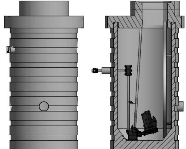
VARIO-FIX-PUMPENSCHACHT mit Doppelpumpanlage
