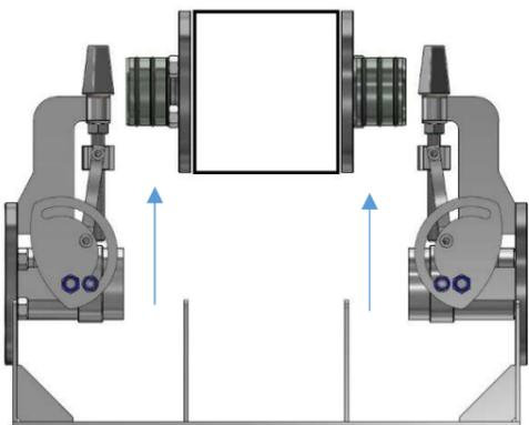
Wasserzähler, Druckminderer, Spül- und Molcheinheit mit Flansche und O-Ringbuchsen werden aus- und eingesetzt
