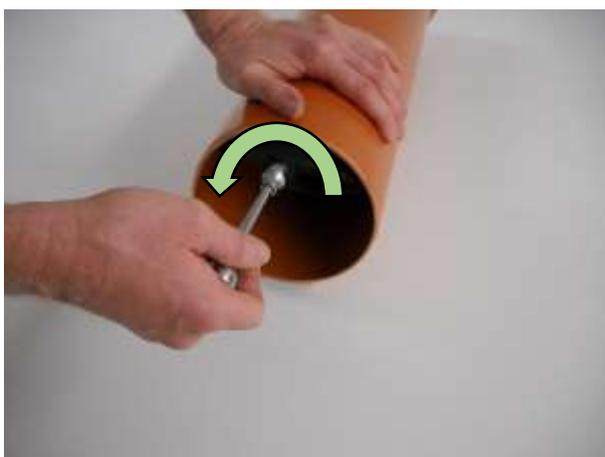
c) Schraube in Pfeilrichtung anziehen (Bild c) bis das Ventil nicht mehr bewegt werden kann. Um ein optimales Funktionieren zu garantieren, muss die Schraube im oberen Scheitelpunkt der Röhre fixiert werden.
